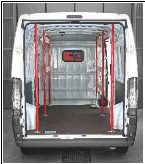
Multiplex-Stecklatten in Kopf-, Bauch- und Knieebene sichern die Sackkarre, ...
