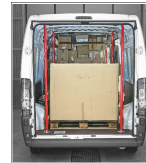
...und die Palettenware wird (gem. Lastverteilungsplan) dagegen gestaut ...
