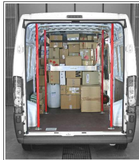
...mittels Sperrstange und Zwischenwandverschluß in rückwärtiger Richtung.
