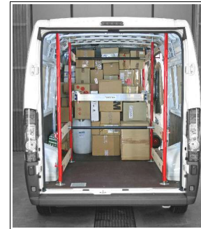
hinten: Stecklatten in Knie- und Fußebene begrenzen seitlich, die Sperrstange hineingesetzt, ...
